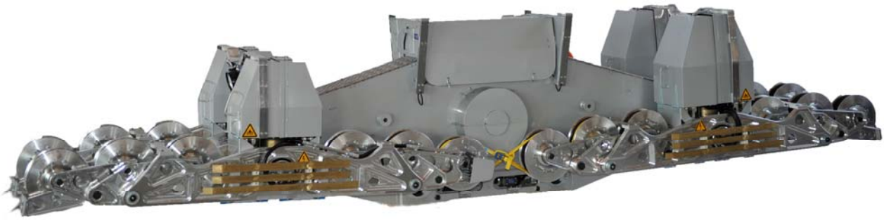
Bild 1. Das neue 24-rollige Laufwerk ist knapp 6 Meter lang. Dominant sind die Abdeckkästen der 4 Fangbremsen, wobei die beiden bergseitigen Bremsen etwas grösser dimensioniert sind.
