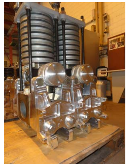
Bild 3 Auch die Fangbremsen sind grossteils in Aluminiumleichtbauweise konstruiert.
